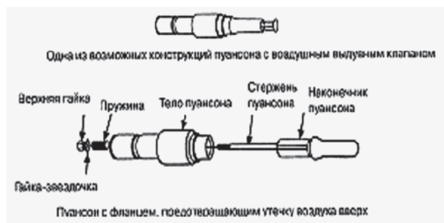
Рис. 3 Возможные конструкции выдувного пуансона.
